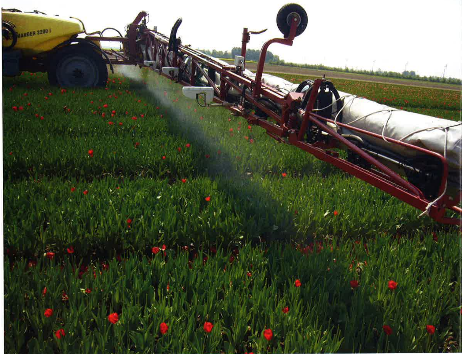
Spuit met sensoren die per sectie kan sproeien.
