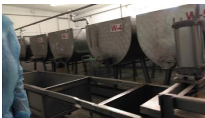
Afbeelding 10: Mengers om kwark te produceren
