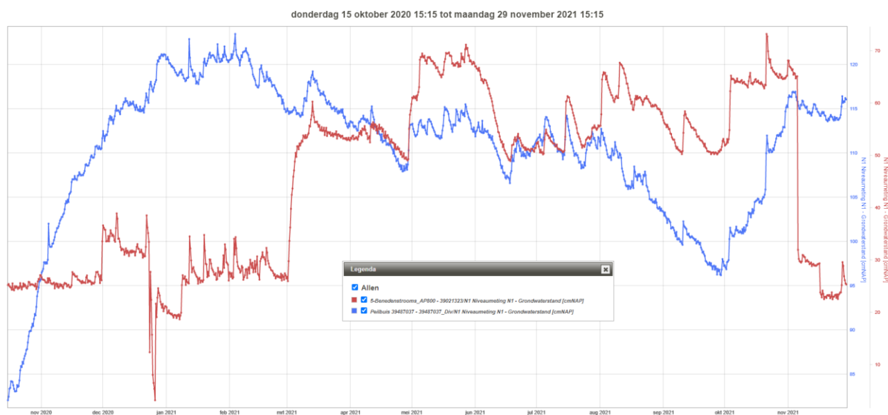
Figuur 2.17: Slootwaterpeil (bruin) en grondwaterstand (blauw) op 225 meter van de helofytensloot.
